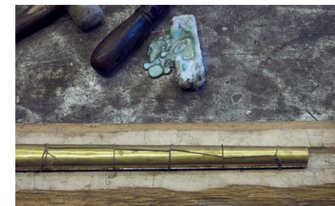
Stagnatura dei bordi delle lamine e assemblaggio delle due porzioni di tubo
