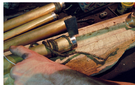
Stagnatura dell'anello di giunzione
