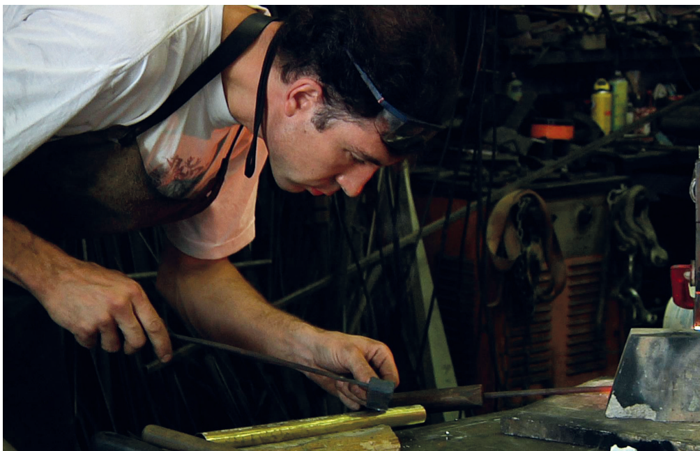
Alessandro Ervas mentre fissa le due metà del karnyx di Sanzeno per la realizzazione del tubo
