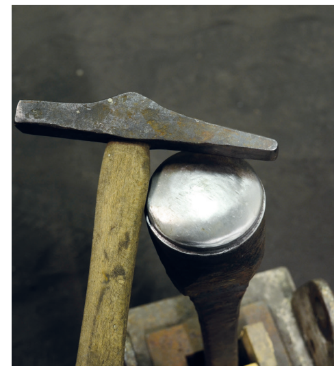
Martelli appositamente creati per la lavorazione del karnyx
