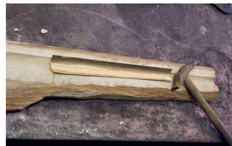
Realizzazione delle sagome in legno per la modellazione tramite battitura delle lamine
