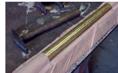
Realizzazione delle sagome in legno per la modellazione tramite battitura delle lamine
